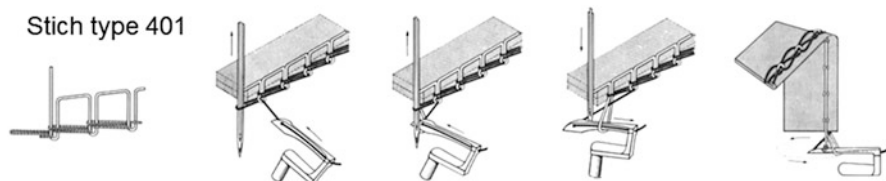
Fig. 12.13 Double chain stitch [12] (Source: Pfaff Industriesysteme und Maschinen AG)
