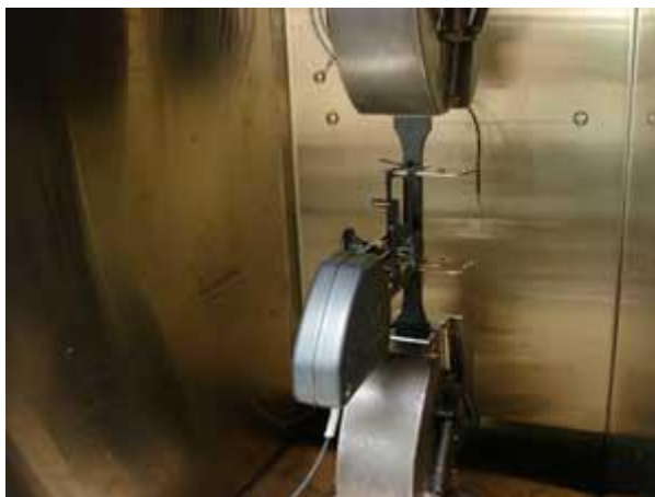
شکل ۱- دستگاه کشش در حال آزمون نمونه دمبل شکل
